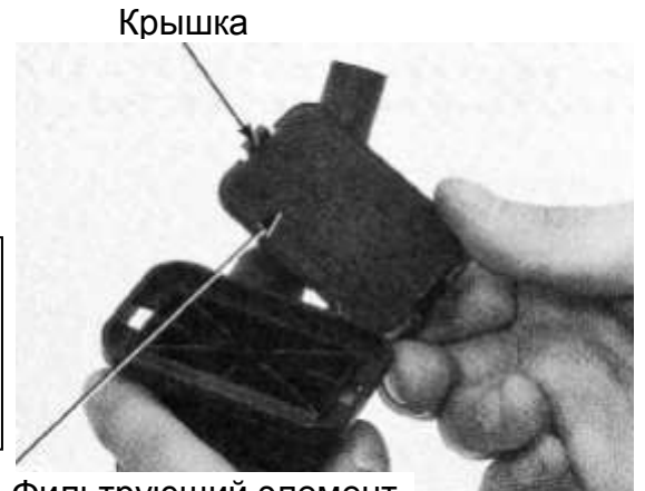
Фильтрующий элемент Трубка воздухо-запорного клапана Топливная трубка
