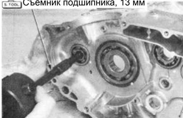
5 TOOL Съёмник подшипника, 13 мм
