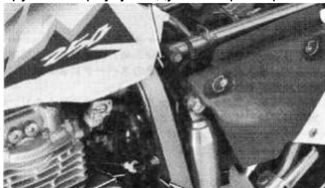
Трубка сапуна двигателя Камера сапуна двигателя
