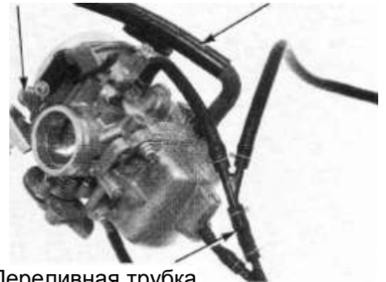
Фильтрующий элемент Трубка воздухо-запорного клапана Топливная трубка
